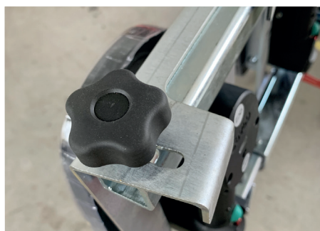
Vnější prodlužovací ramena lze naklopit pro manipulaci klenutých břemen
