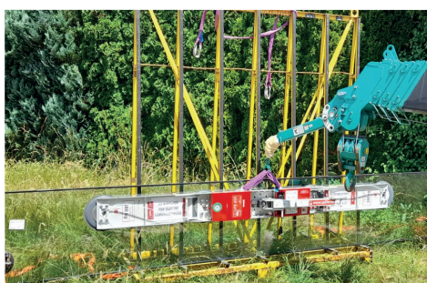
S délkou 2,16 m je UPG 450 ideální pro manipulaci dlouhých a úzkých břemen
